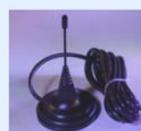
Антенна на магнитной базе работает в диапазонах GSM 872-960 МГц/1710-1885 МГц, обеспечивая работу в стандартах GSM 900/1800, DAMPS/AMPS/CDMA/CDMA2000. Коэффициент усиления - 5 дБ
