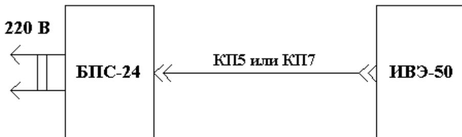
Рис.1. Первый вариант подключения прибора ИВЭ-50 к БПС-24.
