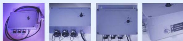
Блок питания стабилизированный БПС-24.3 предназначен для обеспечения стабильного питания электроаппаратуры с номинальным напряжением 24В от сети переменного тока напряжением 220В. К одному блоку допускается одновременное подключение до трех потребителей с суммарной мощностью не более 30 Вт.
