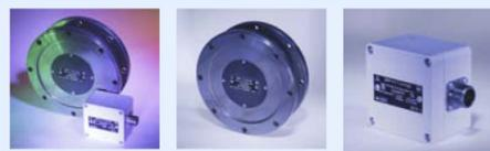
Датчик предназначен для измерения крутящего момента карданного вала, связывающего коробку отбора мощности и цепную передачу бурового ротора, а так же для измерения скорости вращения вала.
