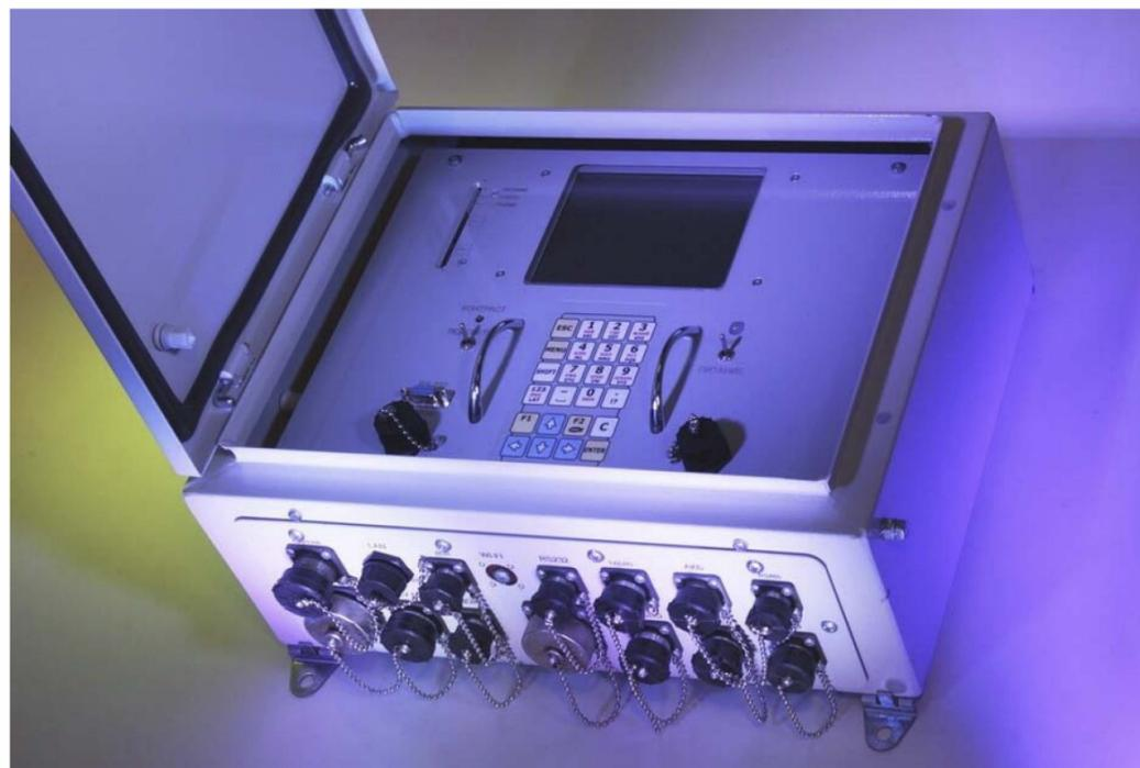
Станция контроля параметров бурения (СКПБ) на основе измерительного комплекса ИВЭ-50 модель 14.3XX представляет собой систему сбора, обработки, визуализации и передачи технологической информации во время проведения всех видов буровых работ.
